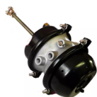
CÂMARA DE SERVIÇO
